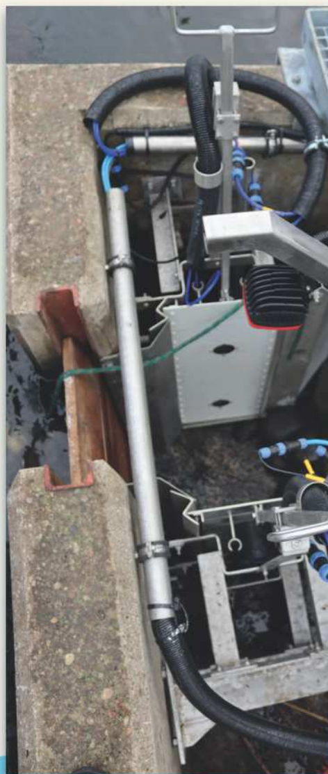
20.1, 20.2. Montaż urządzeń (kamer wizyjnych oraz echosondy) do monitoringu ryb w przepławkach. Na zdjęciu po lewej widoczne są cztery obiektywy kamer umieszczone na jednej płycie. Installation of devices (video cameras and echo sounders) for monitoring fish in fish passes. The photo on the left shows four camera lenses placed on one plate.
